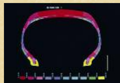
Konstrukce pneumatiky vytvořena pomocí počítače pro získání optimální záběrnosti.
